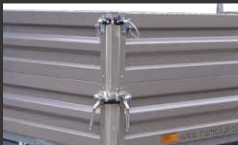
Rehausse de ridelles en acier de 350 mm
